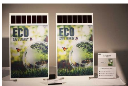
消費電力0Wで表示保持が可能なA2 サイズ ePoster とソーラー発電ユニット
